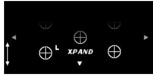
Рисунка 16: Вертикальная Регулировка Нижнего Изображения при помощи Винта I
